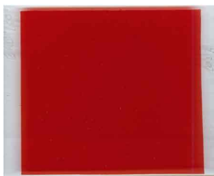
图10 无镉扩散红色，6毫米浮法玻璃，690℃ 5分钟
